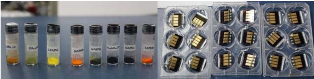
그림 3. 페로브스카이트 용액에 톨루엔을 첨가하여 침전시킨 분말과 개발한 태양전지
