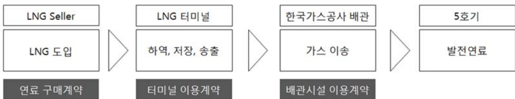
그림 8. 가스 직도입 발전기의 연료처리 흐름도
